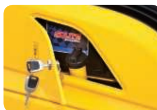
Met sleutel afgesloten tankdop
